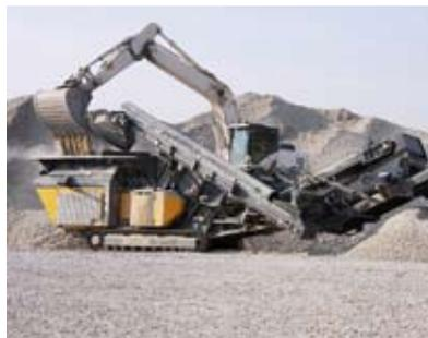
Mit Brechern und Siebanlagen von Rubble Master können Materialien wie Asphalt, Beton, Bauschutt und Naturstein direkt vor Ort zu CE-zertifizierten Körnungen aufbereitet werden.
