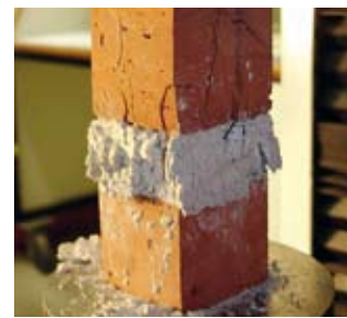
Anhand zahlreicher Materialtests – hier ein Druckversuch – entwickelten die Bauingenieure Materialkennzahlen.
