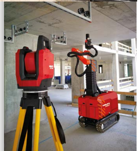
Der semi-autonome Baustellenroboter Jaibot ist ein weiterer Schritt auf dem Weg zur digitalen Baustelle.
