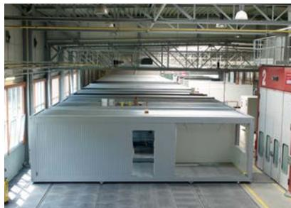
Laborbedingungen in der Produktionshalle wie hier beim Modulbauer Koma Modular ermöglichen fehlerfreies, rasches Arbeiten. Außerdem ist es in Zeiten des Facharbeitermangels einfacher, Mitarbeiter für die Produktion in temperierten Fabriken zu begeistern als für die Baustelle.
