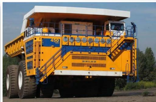
**Platz 9:** Der 20,6 m lange BelAZ 75710 ist mit einer Nutzlast von 450 t und einer Gesamtmasse von 810 t der größte in Serie gefertigte Muldenkipper der Welt.
