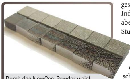
Durch das NewGen-Powder weist das verflüssigte Metall im Schmelzbad eine höhere Stabilität auf.
