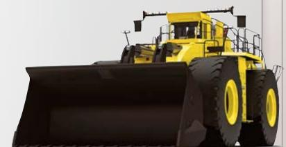
**Platz 10:** Der Komatsu P&H L-2350 mit 2.300 PS und einem Schaufelinhalt von 40,52 m<sup>3</sup> ist mit 19,87 m Länge, 6,76 m Breite und 6,71 m Höhe der größte Radlader der Welt.
