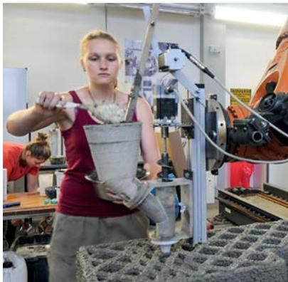
3D-Druck erlaubt die Ausbildung von Vor- und Rücksprüngen in der Bauteiloberfläche sowie von filigranen Hohlraumstrukturen und Kanälen.
