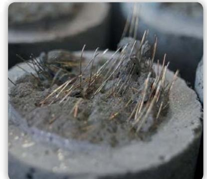
■ **Projekt:** Con Fit – Performanceorientierter Einsatz faser- und textilbewehrter hochfester Betone zur strukturellen Tragwerksertüchtigung
