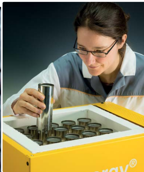
»cerenergy« von Fraunhofer ist eine Hochtemperaturbatterie für die stationäre Energiespeicherung.
