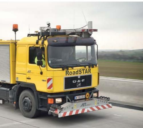
Mit eigens entwickelten Messmethoden wie dem mobilen Labor RoadSTAR (kleines Bild) scannt das AIT das Straßennetz und erhält damit wichtige Daten zum Straßenoberflächenzustand, zur Trassierung und zur Straßenausrüstung. Daraus leitet das AIT Unfallwahrscheinlichkeiten und den idealen Zeitpunkt für notwendige Erhaltungsmaßnahmen ab.
