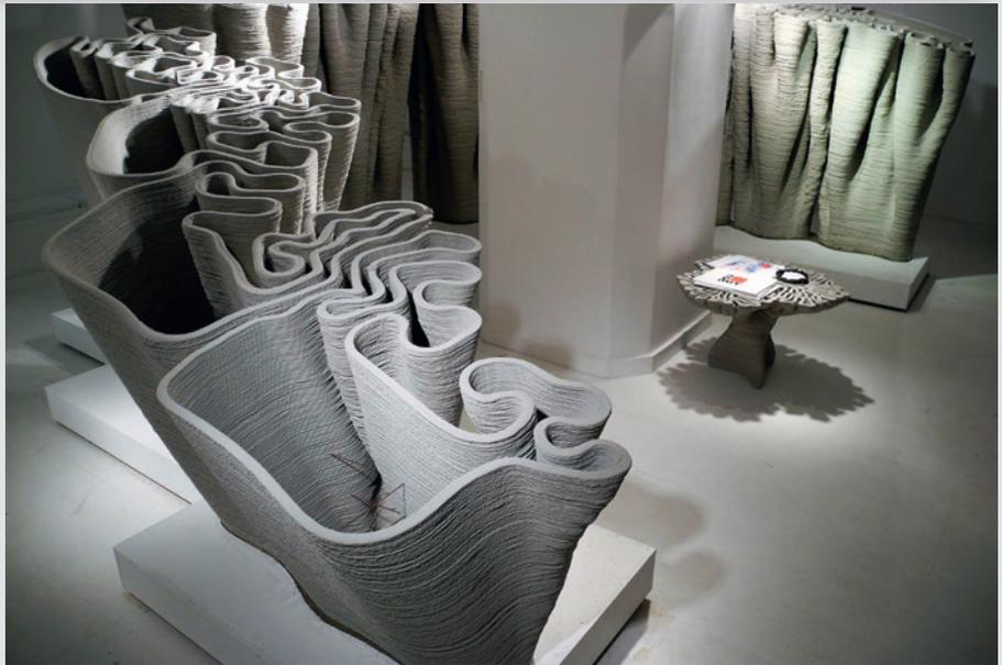
Die mit dem BauMinator® 3DBetondrucksystem gedruckte Installation ist acht Meter lang und zwei Meter hoch. Neben den Wandtrennelementen gibt es auch Sitzmöglichkeiten und Stellplätze für Pflanzen.
