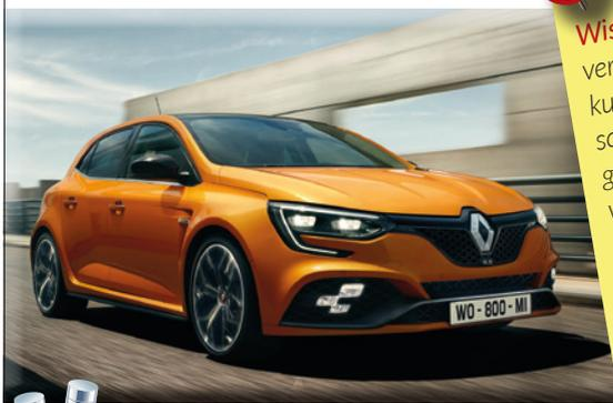
**Wissenswertes:** Der neue Mégane R.S. verfügt serienmäßig über Allradlenkung. Bei niedrigen Geschwindigkeiten schlagen die Hinterräder in entgegengesetzter Richtung zur Vorderachse ein, was Lenk-, Wende- und Parkmanöver erleichtert. Bei höheren Geschwindigkeiten steuern die Hinterräder in die gleiche Richtung wie die Vorderräder. Dadurch werden Fahrsicherheit und Spurstabilität gleichermaßen gesteigert.
