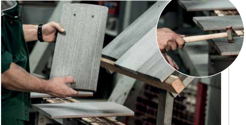
In Gleinstätten werden unter anderem die trendigen Vintage-Dachziegel produziert. Die akustische Qualitätskontrolle wird auch heute noch manuell durchgeführt.
