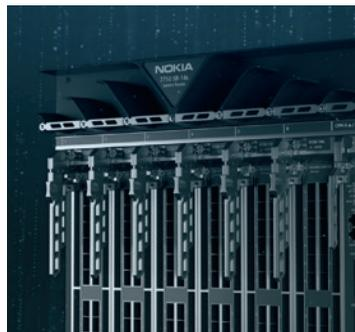
Die Service-Router der Nokia 7750-s-Serie sind Routing-Plattformen mit der branchenweit höchsten Dichte, die 144 TB/s-Konfigurationen in einem einzigen Rack unterstützen. Die neuen Nokia-Plattformen sind die branchenweit ersten, die IP-Ströme im Terabit-Bereich unterstützen.
