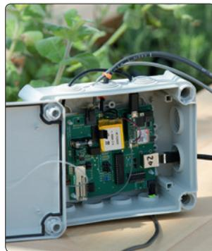
In dem M2M-Showcase »ConnectedGarden« vernetzt eine IoT-Box von T-Mobile ein »SmartBeet«, um Messwerte wie Feuchtigkeit der Erde übertragen zu können.
