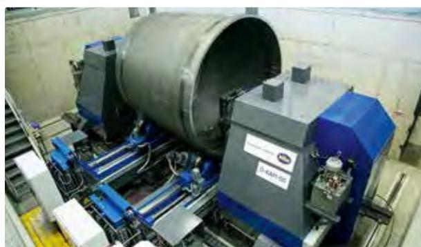
Der Technologiehersteller Miba übernimmt eine wichtige Rolle am Energiesektor. Im Bild: beidseitige Rundnahtprofil-Fräsmaschine
