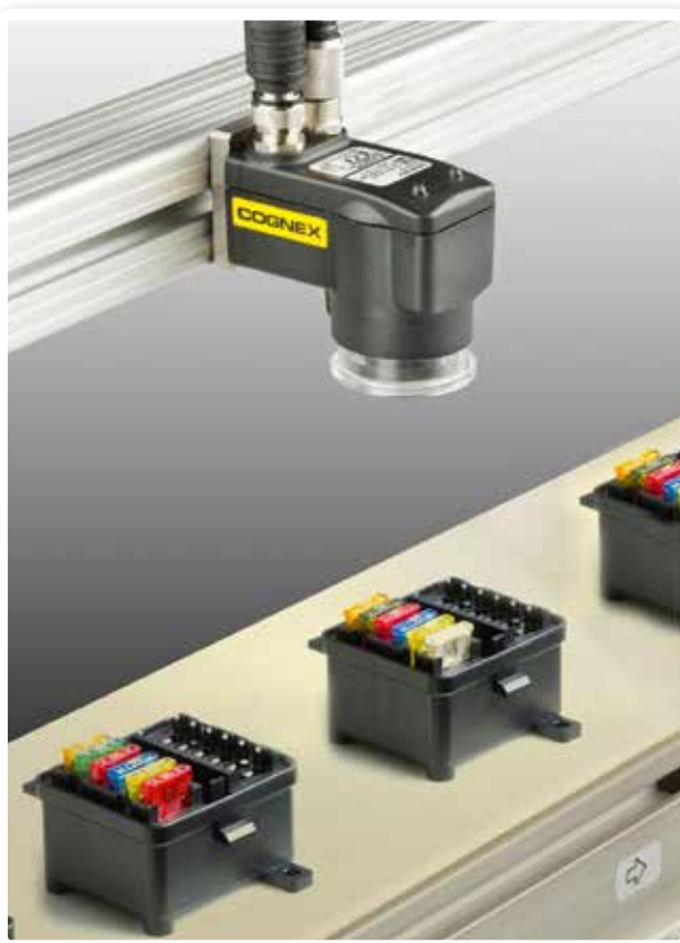
Teilerkennung des Checkers 4G7C durch Lokalisieren eines Merkmals auf dem Teil, nicht nur einer Kante.
