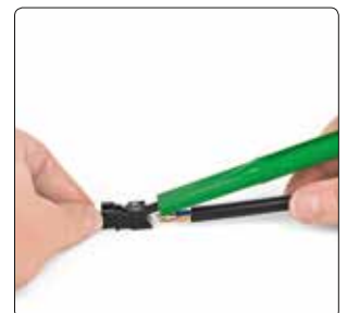
Werkzeug für Leiteranschluss für Winsta-Familie von Wago..
