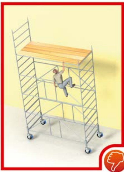
„Fahrbare Gerüste immer nach den Herstellerangaben errichten und benützen, besonders auf eine ausreichende Aufstandsweite achten.“
