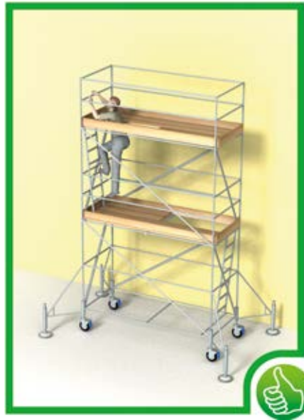
„Fahrbare Gerüste immer nach den Herstellerangaben errichten und benützen, besonders auf eine ausreichende Aufstandsweite achten.“
