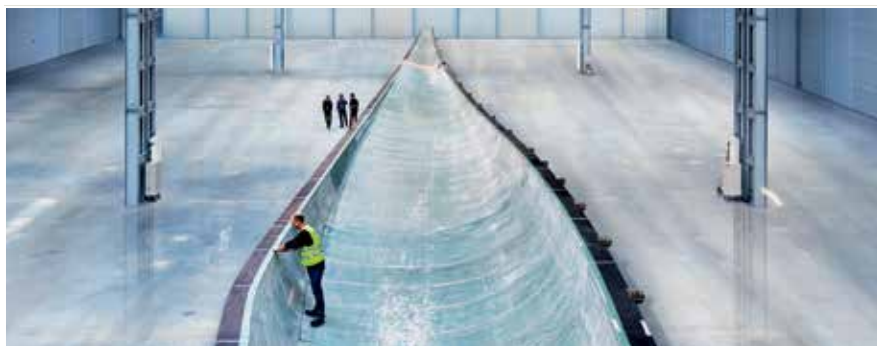
Das Rotorblatt B75 von Siemens ist die weltweit größte aus Glasfaser hergestellte Industriekomponente aus einem Guss.
