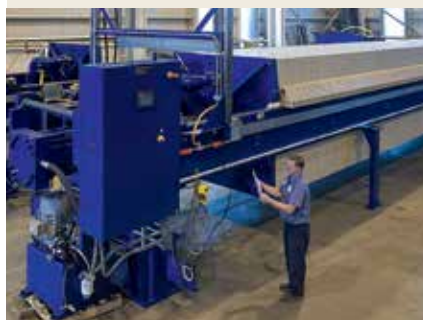
Seitenholm-Filterpressen werden in Abwasseraufbereitungsanlagen zur Schlammwässerung eingesetzt.
