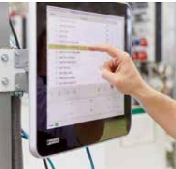
Neue Panel-PCs von Phoenix Contact sind extrem staub-, kälte- und wasserfest.
